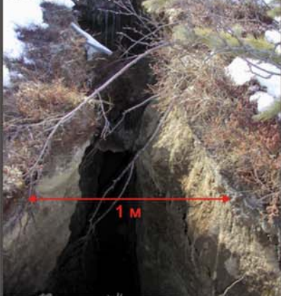
Фото. Участок 5, одна из зияющих трещин вдоль сейсморазрыва, GPS 293
