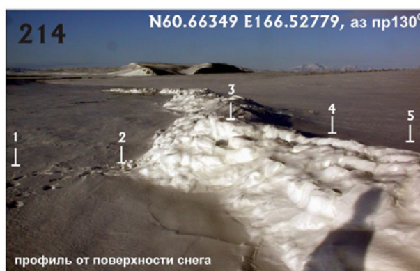
Рис. 4-а. Топографические профили через участки сейсморазрыва с преобладающей взбросовой компонентой. По горизонтальной шкале на графиках отложены порядковые номера замеров. Азимуты профилей измерены между направлением на север и линиями профилей в направлении от лежачего крыла к висящему. На профилях 208-214 замеры выполнены от поверхности снежного покрова, на остальных профилях - от поверхности земли.
