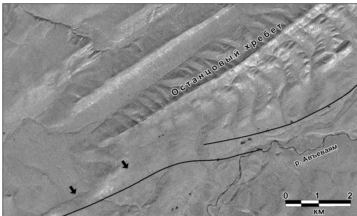
Рис. 2.21. Фрагмент космоизображения Landsat. Стрелками показан разлом, сместивший сопку. Черная линия – сейсморазрыв 2006 г. (т.8 на рис. 2.11).
