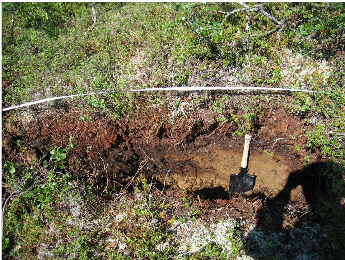
Рис. 2.20. Канава пройденная вкрест простирания взбросового разрыва.
