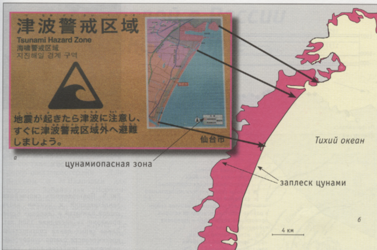
Рис.7. Схема цунамиопасной зоны в окрестностях г.Сендаи (а) и карта фактического заплеска (б) для того же района [5].
