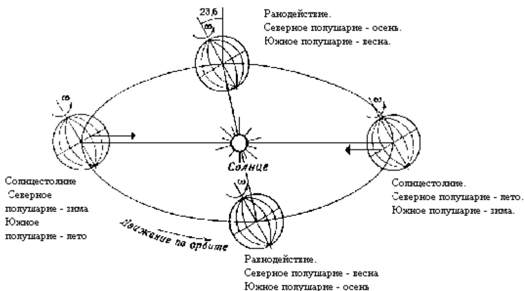
Рис. 2.3. Причина прецессии земной оси. Гравитационное воздействие Солнца на экваториальное вздутие создает момент одного и того же направления во время обоих солнцестояний и не создает никакого момента во время равноденствий.
