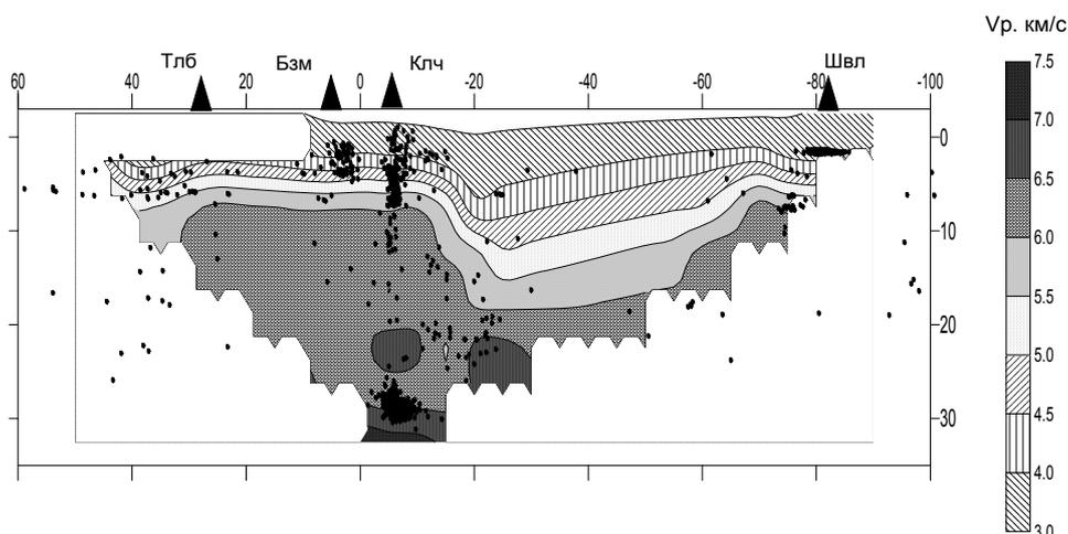
Поле скорости характеризуется достаточно ровным и спокойным поведением изолиний. Изолиния скорости 6.0 км/с под вулканами Ключевской и Безымянный фиксируется на глубине 8-10 км, при  $X=-20$  км наблюдается ступенеобразное погружение до глубины 18-20 км, с последующим подъемом в направлении вулкана Шивелуч. Следующий разрез построен для интервала 01.06-01.10.2008 г.
