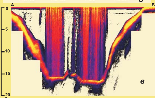
Рис. 5. Результаты батиметрической съемки озера Кипящее: а - гипсометрическая модель; б - батиметрическая схема, изобаты проведены через 1 м.; в - эхолотный профиль по линии АБ.
