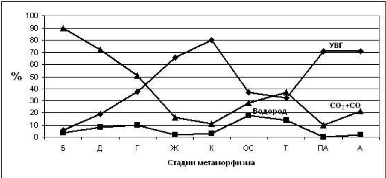
Рис. 2. Динамика выделения окиси и двуокси углерода, УВГ и водорода в опытах с гумусовыми углями последовательного углефикационного ряда.
